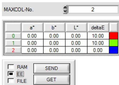
In diesem Beispiel wurde **MAXCOL-No.** = 2 ausgewählt, d.h., der Sensor soll die Farbinformationen wieder finden, welche in den ersten 2 Zeilen der **TEACH TABLE** durch externes Lernen über IN0 abgespeichert werden. Da sich der Sensor seine Toleranzen **deltaE** nicht selbst berechnen kann, müssen diese Werte einmalig eingegeben werden (hier überall 10) und zusammen mit **MAXCOL-No.** sowie **EXTEACH = ON** im **EEPROM** abgespeichert werden.
